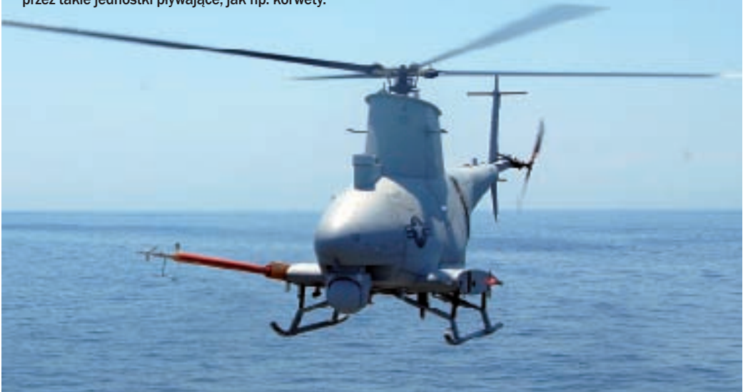
FOT. 1. MARYNARKA WOJENNA USA prowadzi intensywne badania nad wykorzystaniem śmigłowców bezzałogowych przez takie jednostki pływające, jak np. korwety.
